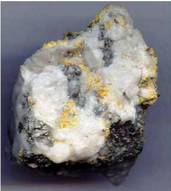
Рис. 30. Обильное золото (пробность 870) в жильном кварце с гнёздами крупнокристаллического арсенопирита и с тетраэдритом. 9 см. Бестюбе-Центр, горизонт – 610 м.
