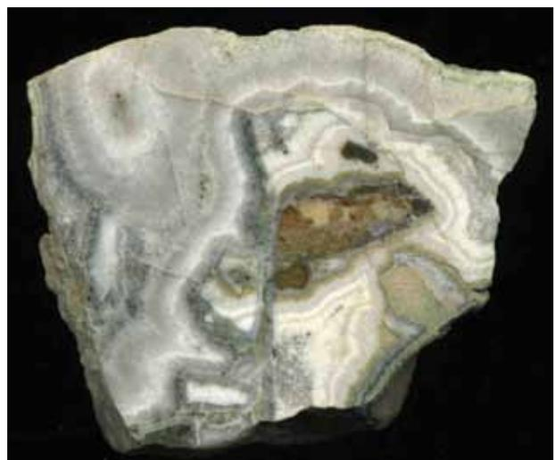
Рис. 12. Типичные брекчиевидные и полосчатые текстуры вулканогенных рудных жил, образованные при неоднократном наслаивании расщеплённых агрегатов халцедоновидного кварца и адуляра (белёсый). Чёрное – теллуриды и иные рудные минералы. 6 см. Агинское месторождение, Камчатка.
