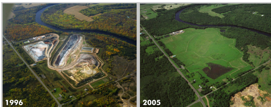
Аэрофотосъемка карьера на руднике Фламбо до и после успешной закладки выработанного пространства. Фото: Эплайд Экологджикал Сервисиз
